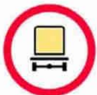
Accesul interzis vehiculelor care transportă mărfuri periculoase
